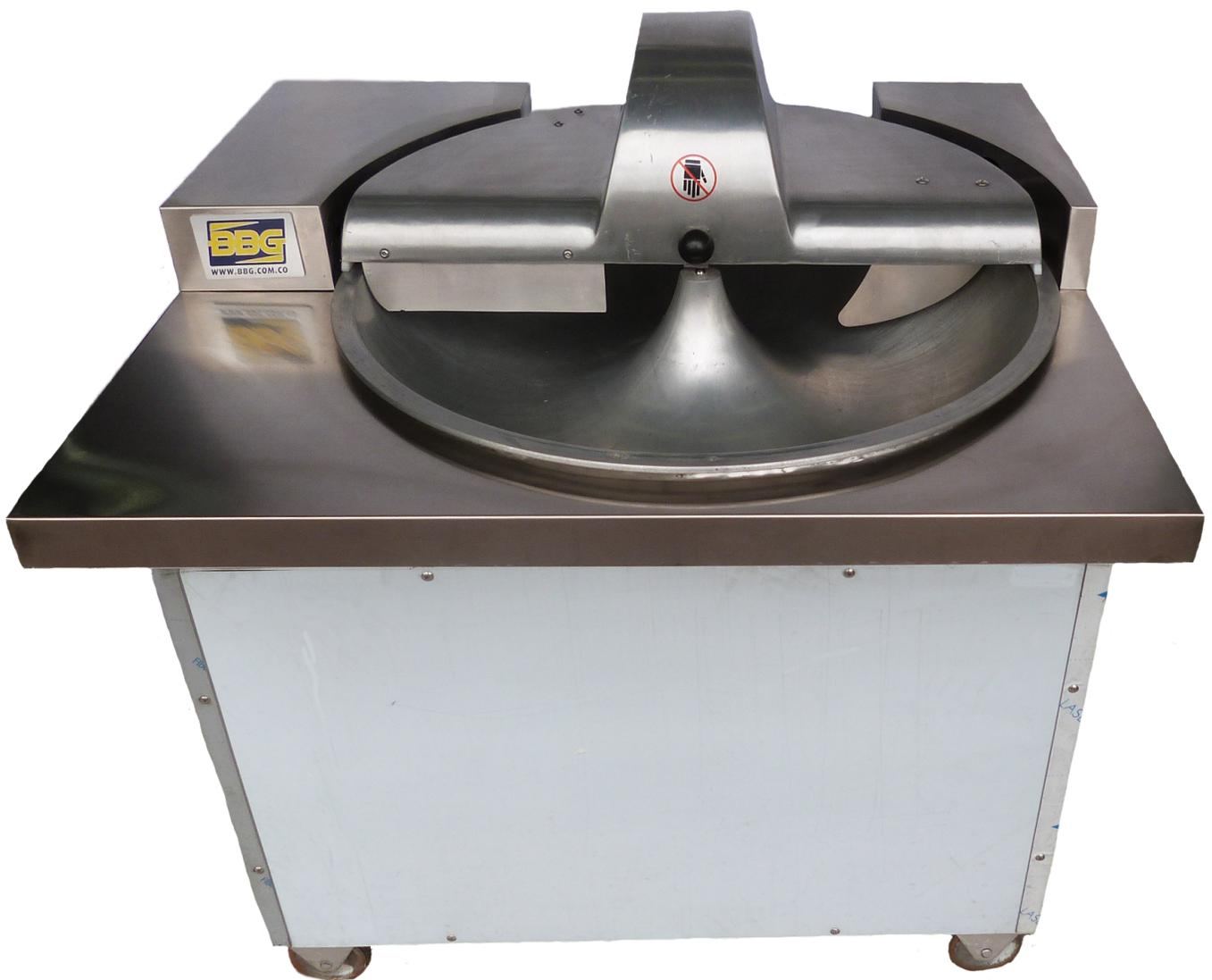
**El cutter es una maquina en la industria de cárnicos y vegetales , se utiliza para la fabricación de todo tipo de embutidos de alta calidad como: embutidos crudos, hervidos y cocidos, patés y conservas, para la trituración optima y rápida, en una sola operación de trabajo.**
