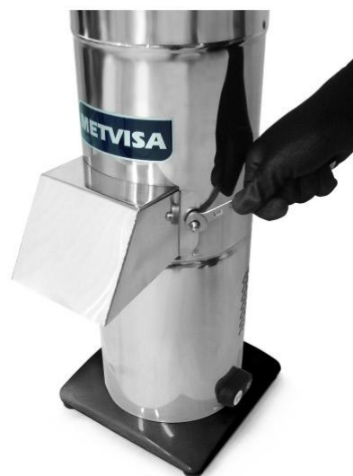
Retire las tuercas del colector para acceder al tamiz
