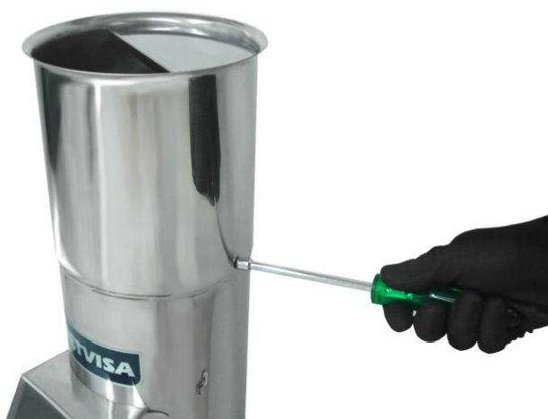
Retire los tornillos para desmontar la protección
